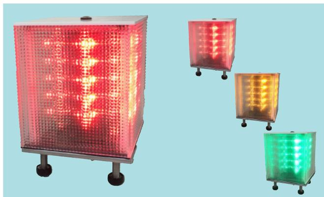
本器は、既存の気象観測装置(風速、雨量計等)に接続することで警報設定値を超えた場合に連動して色が変わるように設計されています。従来の回転灯では積層型を用いてどの色が点灯しているかを見分けていましたが、本器は警報連動で3色に自動で色が変化します。最大の特徴は接続が極めて簡単なことです。RS-485通信ケーブル(LANケーブルを代用)を用いて電源や信号の接続を全て1本で行うため、対応の風速計メーターや雨量データロガーとLAN接続を「カチッ!」とするだけです。煩わしい配線や電源確保の必要は全くありません。
