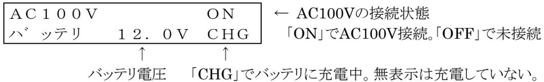
AC100Vが「OFF」の時、本機はDC12Vで動作しています。
