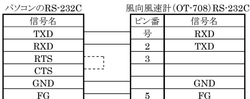
注) 実線の接続方法で通信がうまく行かない場合は、破線も接続して下さい。
